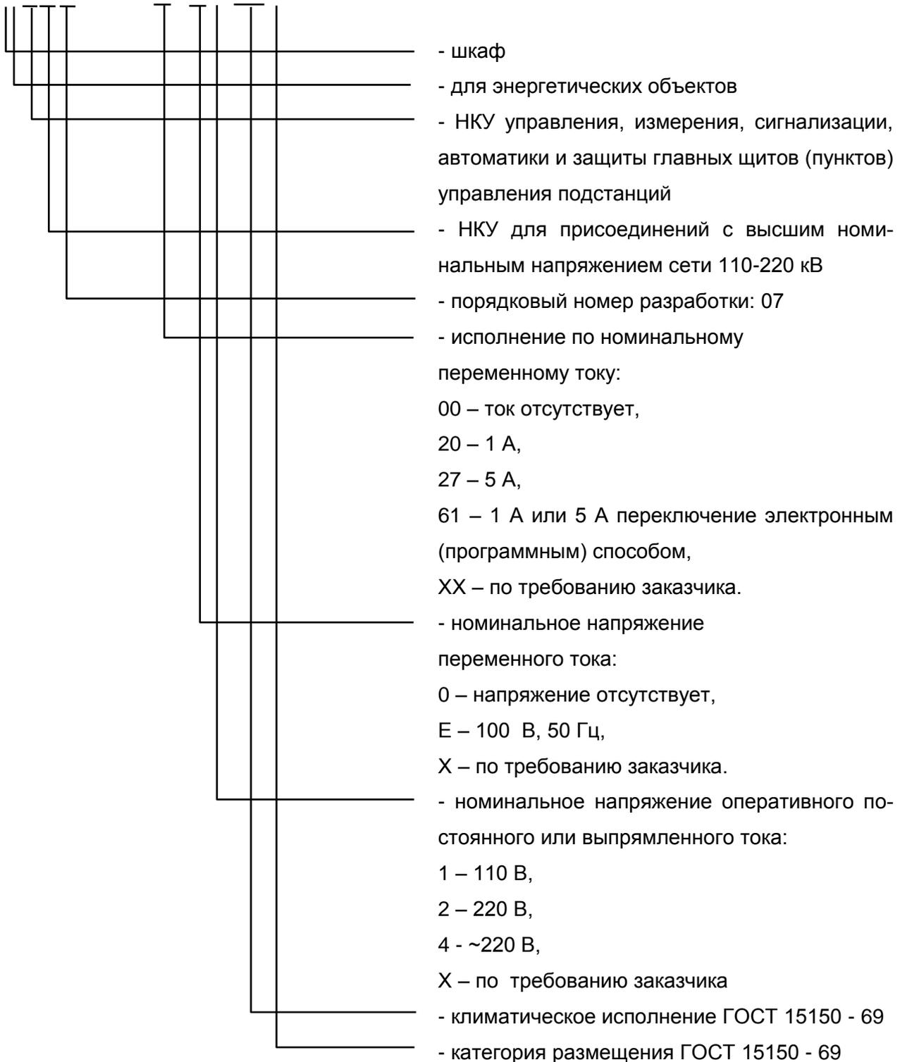
Пример записи обозначения шкафа ШЭ2607 141 на номинальный переменный ток 5А, номинальное напряжение переменного тока 100 В частоты 50 Гц, номинальное напряжение оперативного постоянного тока 220 В:
